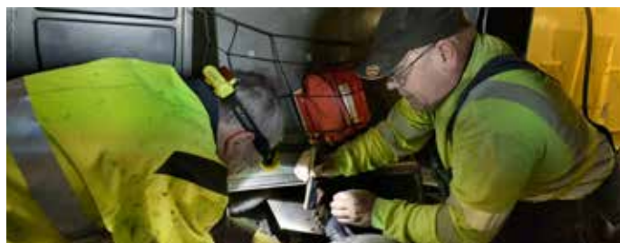
Pär Franzén (t v) och Anders Cederholm monterar parkeringsbroms på bandvagn.
